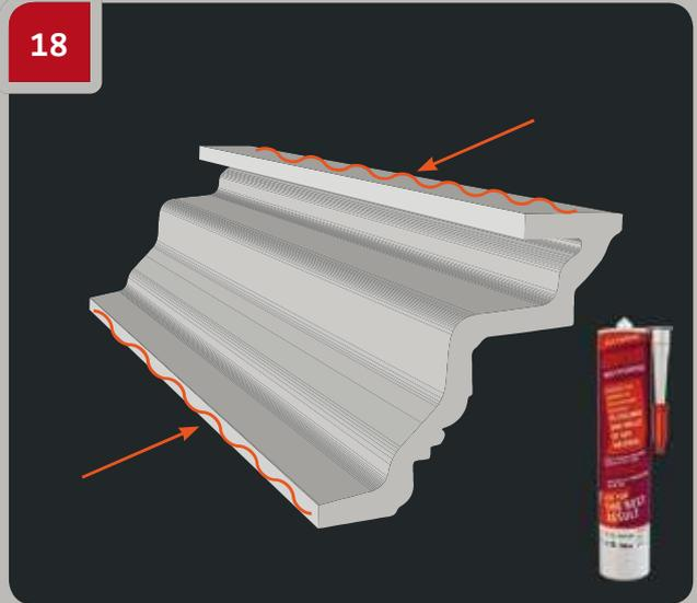
Etaler de la colle G10U290 tout le long de l'élément suivant à monter (sur la surface à fixer). La couche de colle doit être de 3 à 5 mm d'épaisseur.
