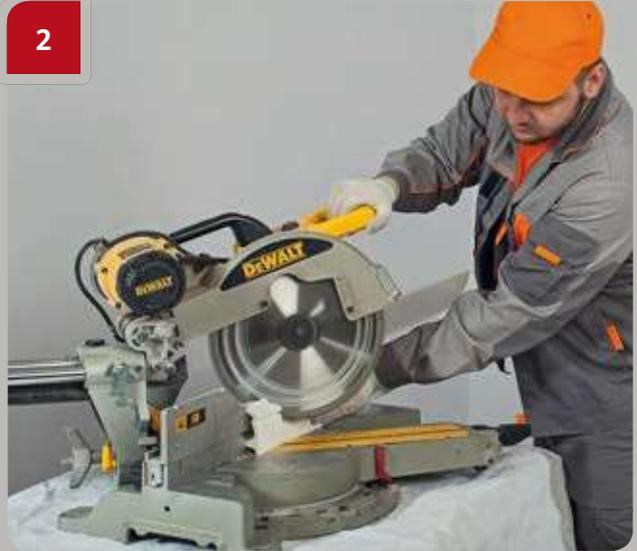
Régler l'angle sur la scie à onglet, couper le produit. Dans les pièces ayant des angles de 90°, il est possible d'utiliser une boîte à onglet et une scie à main.
